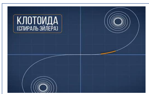
Рисунок 1. Клотоида или спираль Эйлера.
