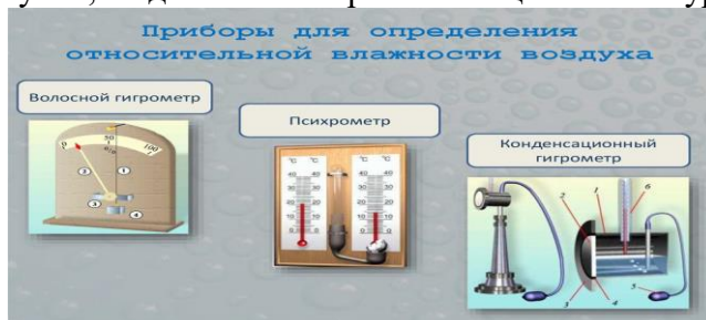
Рис.2 Приборы для определения относительной влажности воздуха
