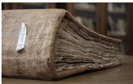
Рис. 1 Перепады влажности приводят к образованию волнистого рельефа, разрушению и «старению» бумаги.
