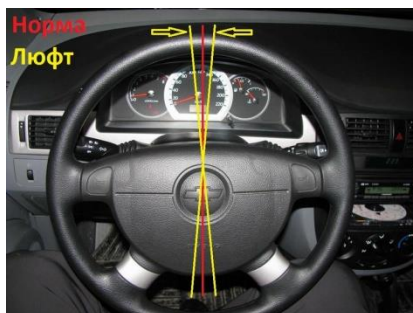
Рисунок 3 - Регулировка люфта рулевого управления
