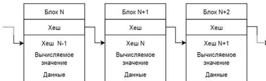
Рисунок 1. Общая схема цепи блоков и их связи
