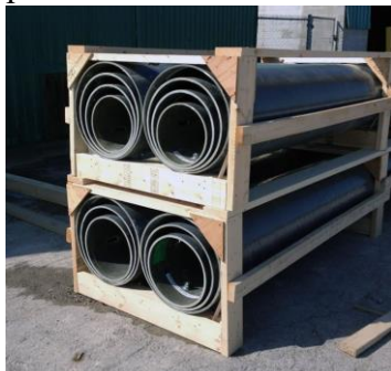
Рисунок 2 - Принцип хранения и перевозки композитных опор
