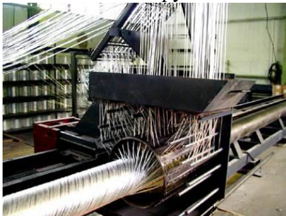
Рисунок 1 - Изготовление композитной опоры
